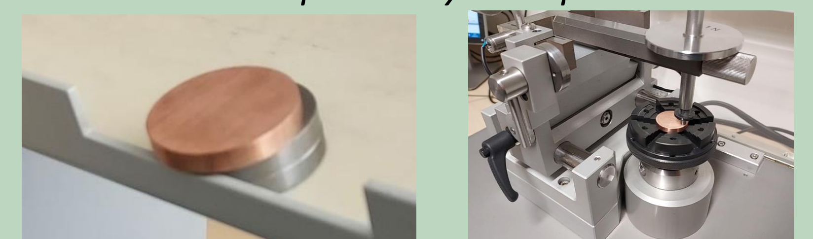
Figure 11. Essais statiques et dynamiques de tribométrie.
